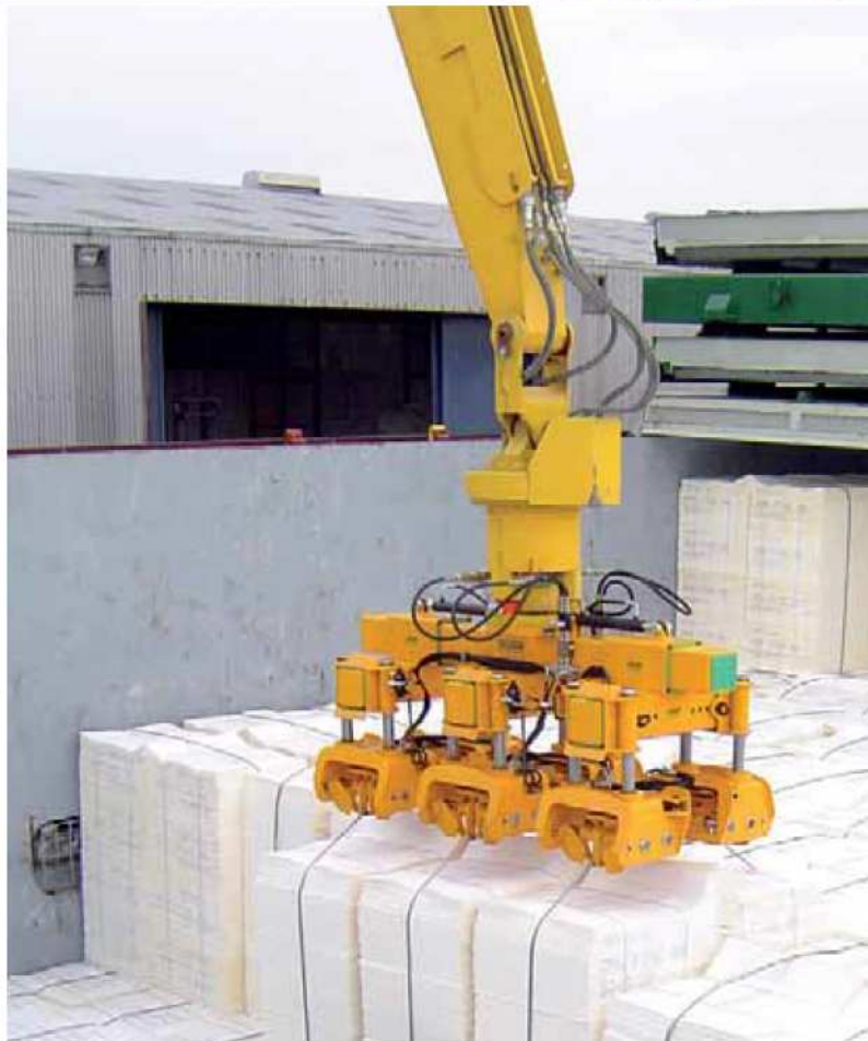
Spreader für den Zellstoffumschlag spreader for pulp material handling
