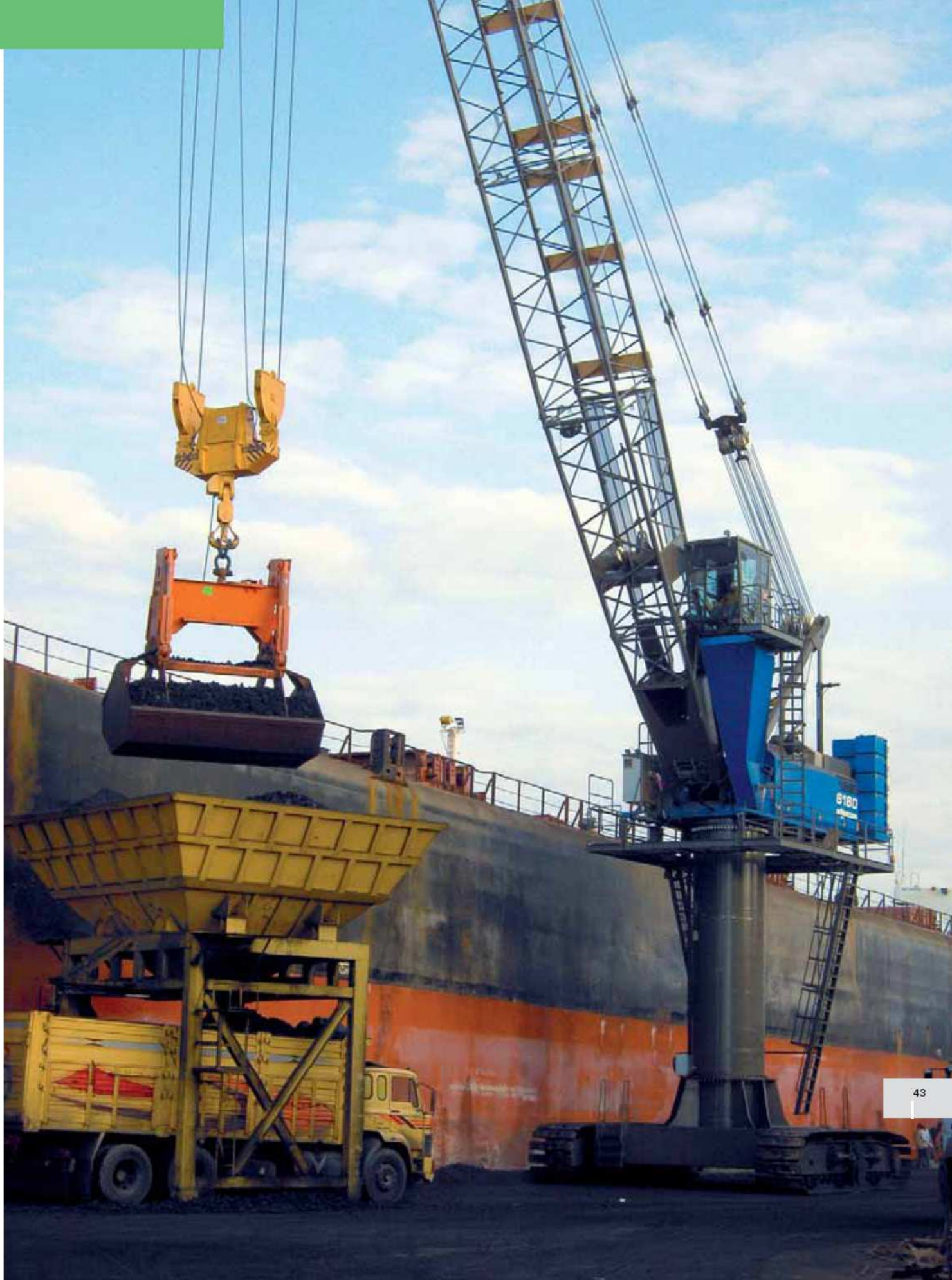
6180 HCC mit 8 m Pylon - 33 m Auslegerlänge - Kohleumschlag mit elektro-hydraulischem Zweischalengreifer 25 m 3 am Drehhaken - Türkei 6180 HCC with 8 m pylon - 33 m boom length - coal handling with electro-hydraulic clamshell grab 25 m 3 on rotating hook - Turkey
