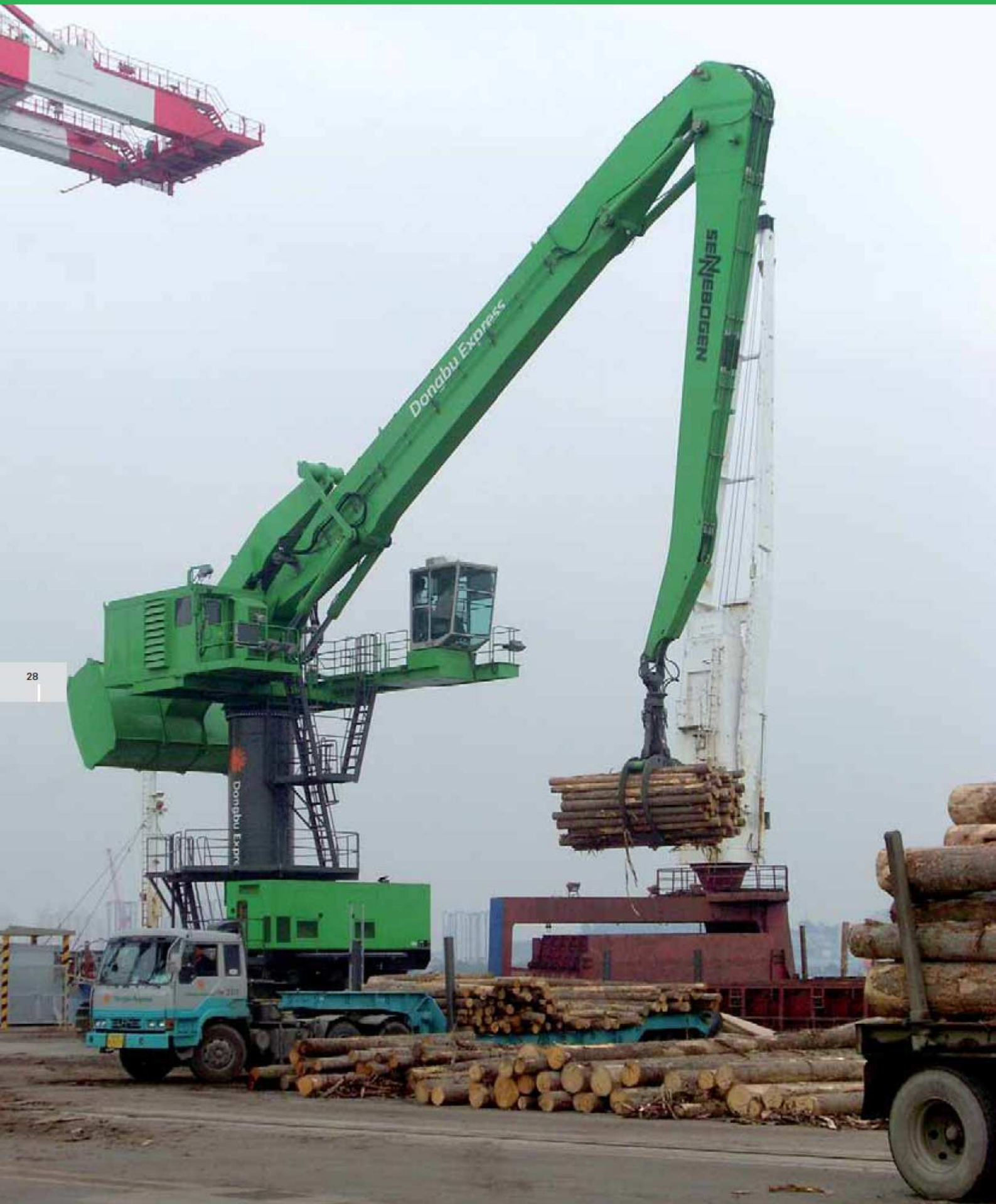
880 EQ R spezial Elektro mit alternativem Dieselantrieb über Powerpack - Ausrüstung K33 - Holzumschlag mit Holzgreifer 2,5 m 2 - Süd Korea 880 EQ R special electro with alternative drive diesel engine via powerpack - equipment K33 - timber handling with timber grab 2.5 m 2 - South Korea
