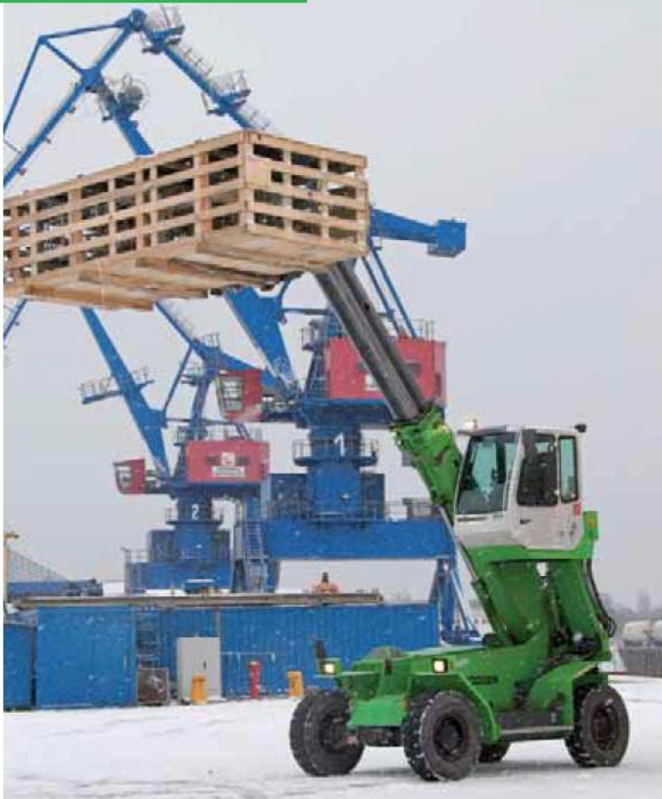
305 Multihandler - Hubgabelinsatz für das Heben schwerer Lasten auf über 7 m Höhe - Deutschland 305 Multihandler - fork lift application for lifting heavy goods up to a height of 7 m - Germany
