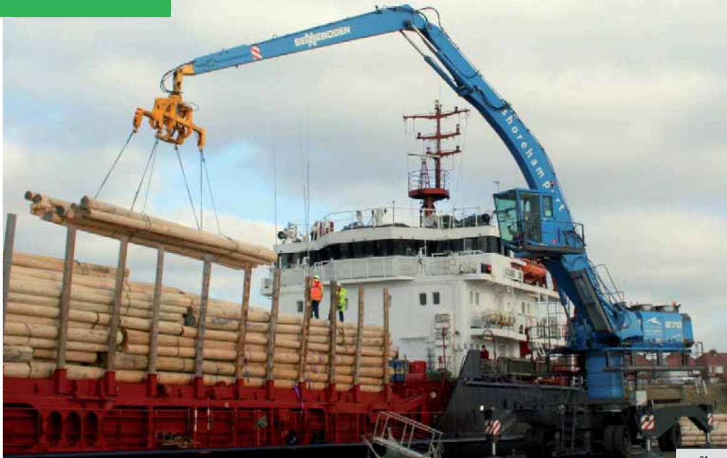
870 M spezial - Sternunterwagen DS100 - Ausrüstung B23 - Holzumschlag mit Traverse - England 870 M special - star undercarriage DS100 - equipment B23 - timber handling with cross-head - England
