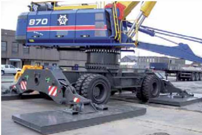
Große Abstützplatten zur Verringerung des Bodendrucks large support plates for reduced ground pressure
