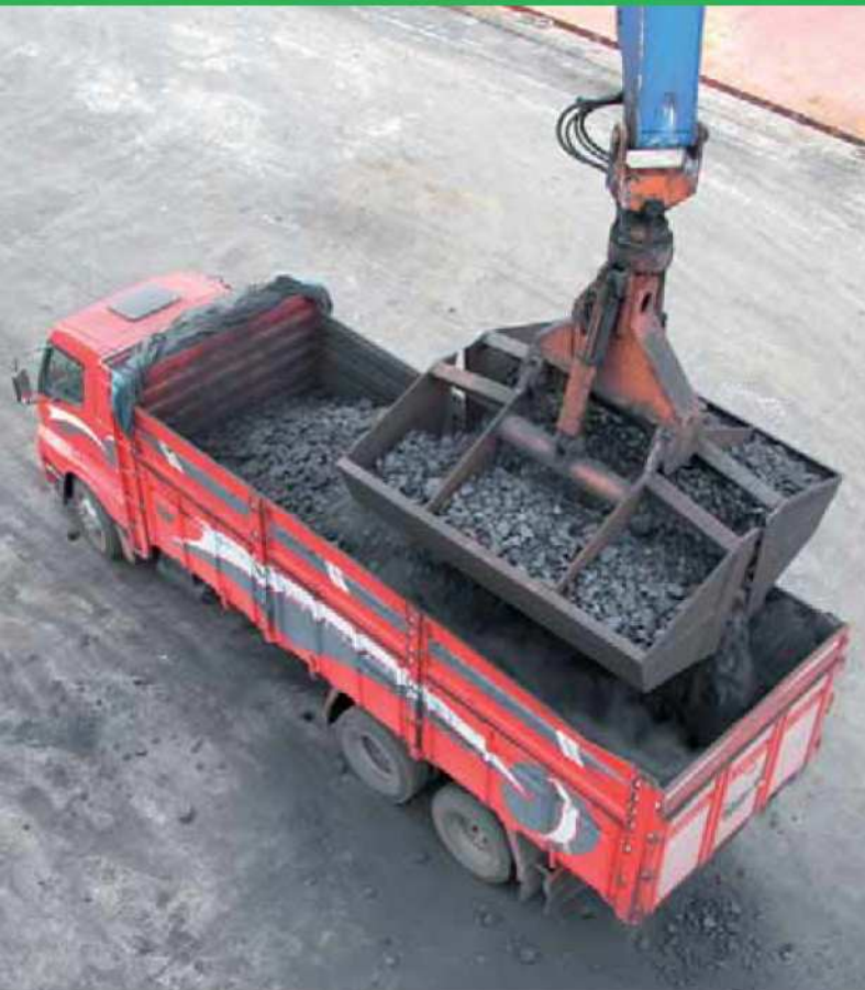
Zweischalengreifer für den Kohleumschlag clamshell grab for coal handling
