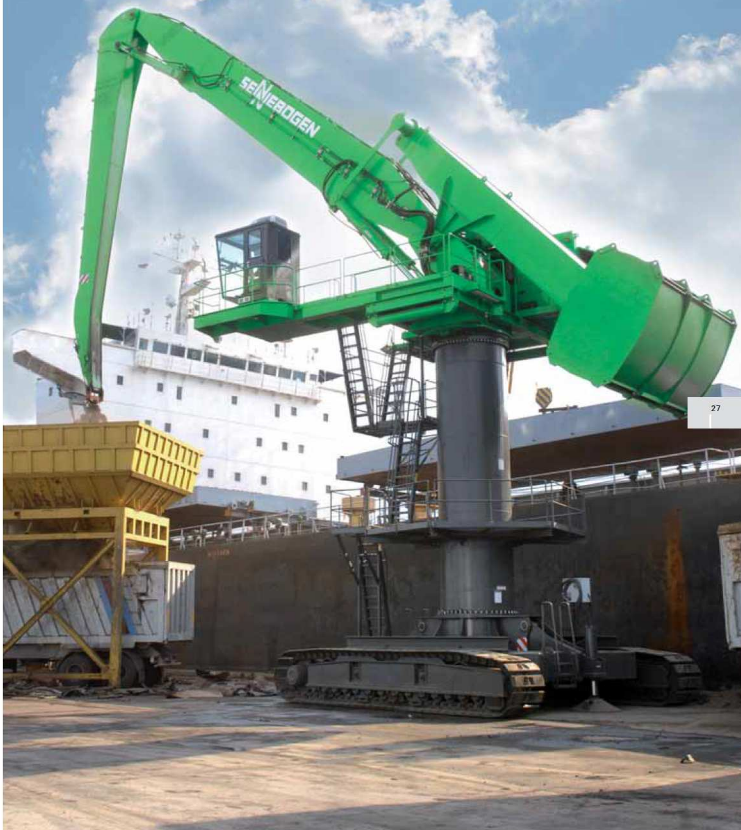
880 EQ R spezial - Ausrüstung K30 - Schrottschlag mit Mehrschalengreifer 8 m³ - Türkei 880 EQ R special - e equipment K30 - scrap handling with orange-peel grab 8 m³ - Turkey
