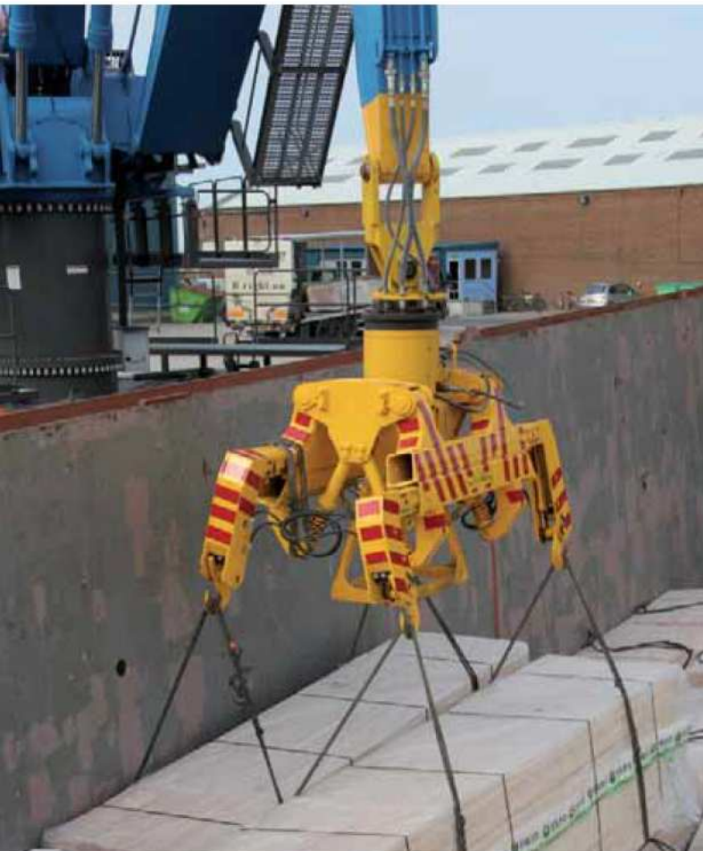
Spreader für den Paketholzpalettenumschlag spreader for wooden pallets handling
