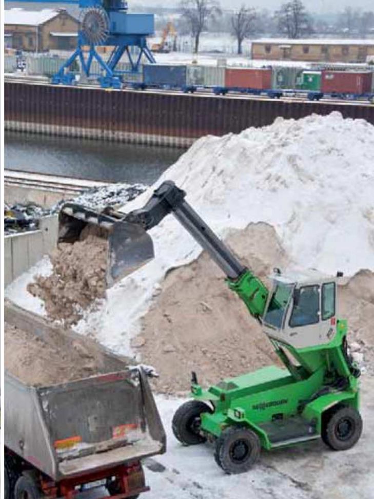
305 Multihandler - Flussspatbeladung auf LKW mit 3 m³ Schaufel - Deutschland 305 Multihandler - fluovite loading on trucks with 3 m³ shovel - Germany
