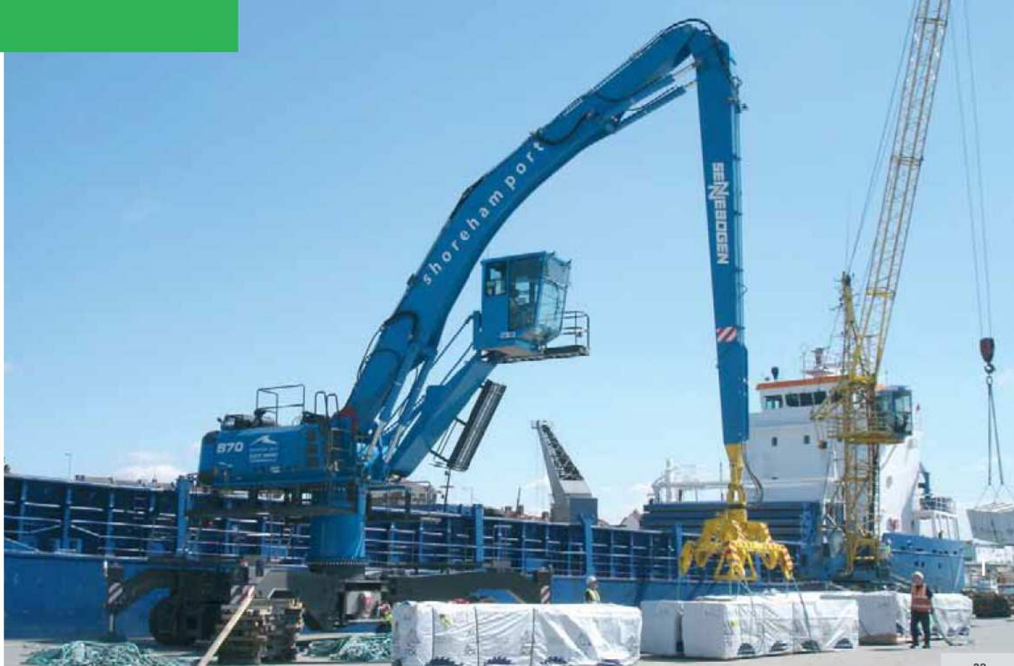
870 M spezial - Sternunterwagen DS100 - Ausrüstung B23 - Holzpalettenumschlag mit Traverse - England 870 M special - star undercarriage DS100 - equipment B23 - timber pallets handling with cross-head - England
