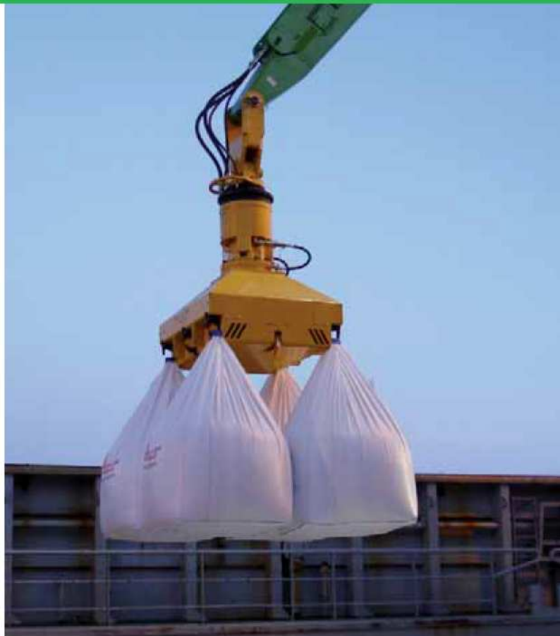
Spreader für den Big Pack Umschlag spreader for big pack handling
