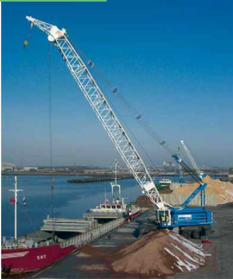
6180 HMC - 36 m Auslegerlänge mit Schnabelausleger - Schüttgutumschlag - England 6180 HMC - 36 m boom length with auxiliary jib - bulk handling - England
