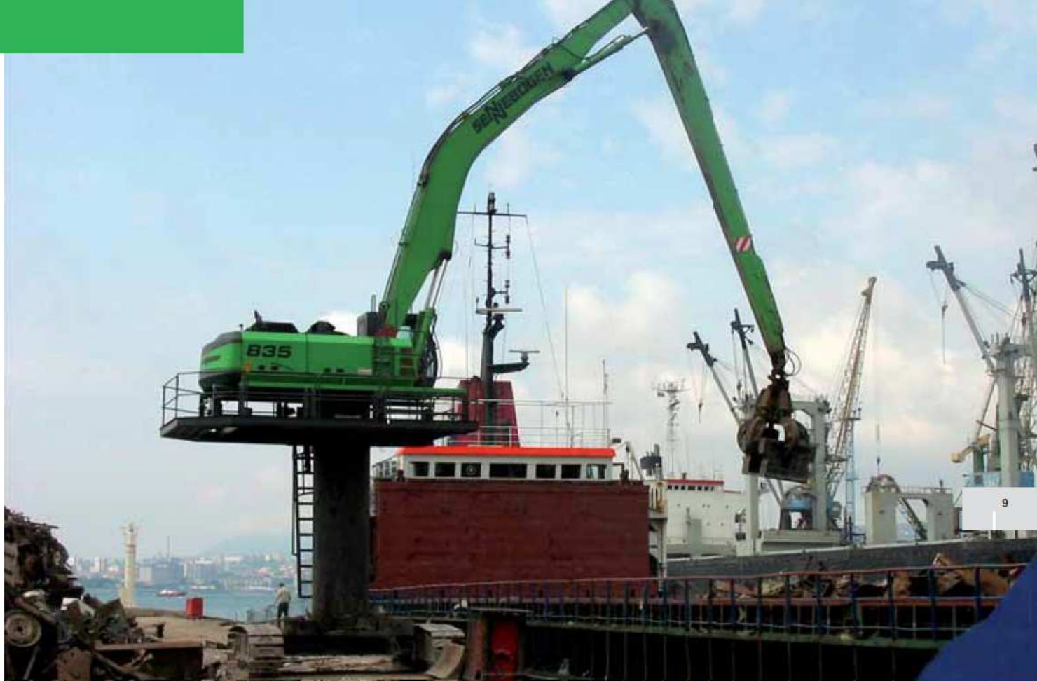
835 R spezial - 5 m Pylon - Ausrüstung B19 - Schrottschlag mit Mehrschalengreifer - Russland 835 R special - 5 m pylon - equipment B19 - scrap handling with orange-peel grab - Russia
