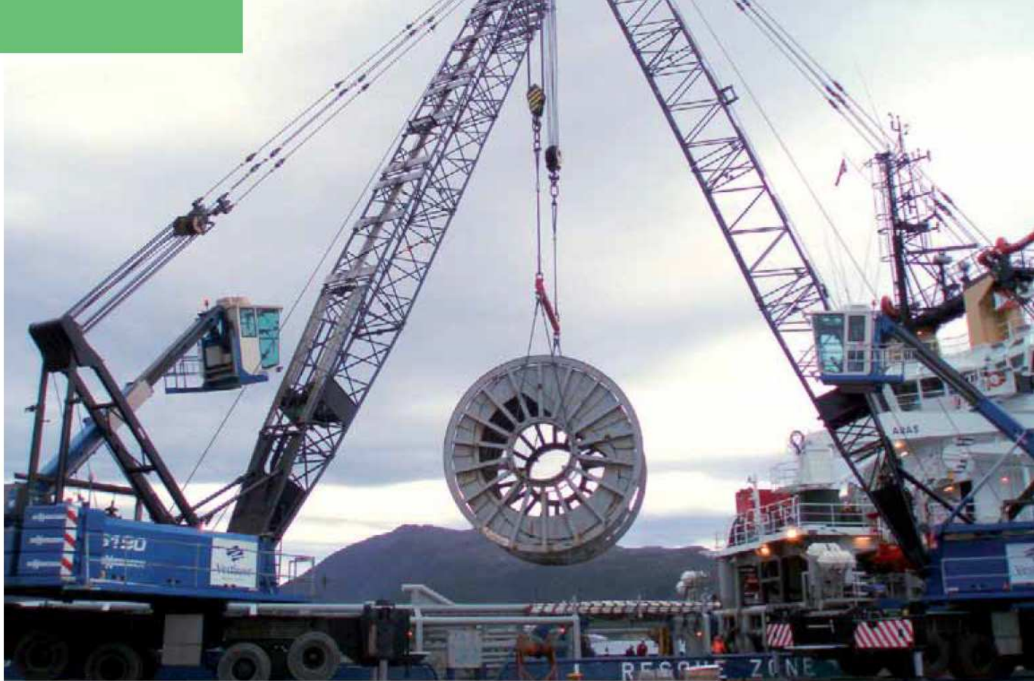
2 x 6180 HMC mit teleskopierbarer Kabine - je 36 m Auslegerlänge - 2 x 20 t Kranwinde - Schwerlastumschlag im Tandemlift - Norwegen 2 x 6180 HMC with telescopic cabin - each 36 m boom - 2 x 20 t crane winch - heavy duty lift in tandem lift operation - Norway
