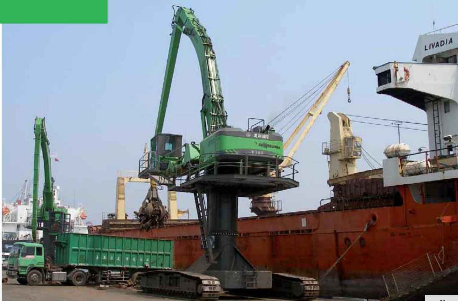
870 R spezial - 5 m Pylon - Ausrüstung B23 - Schrottschlag mit Mehrschalengreifer - Taiwan 870 R special - 5 m pylon - equipment B23 - scrap handling with orange-peel grab - Taiwan
