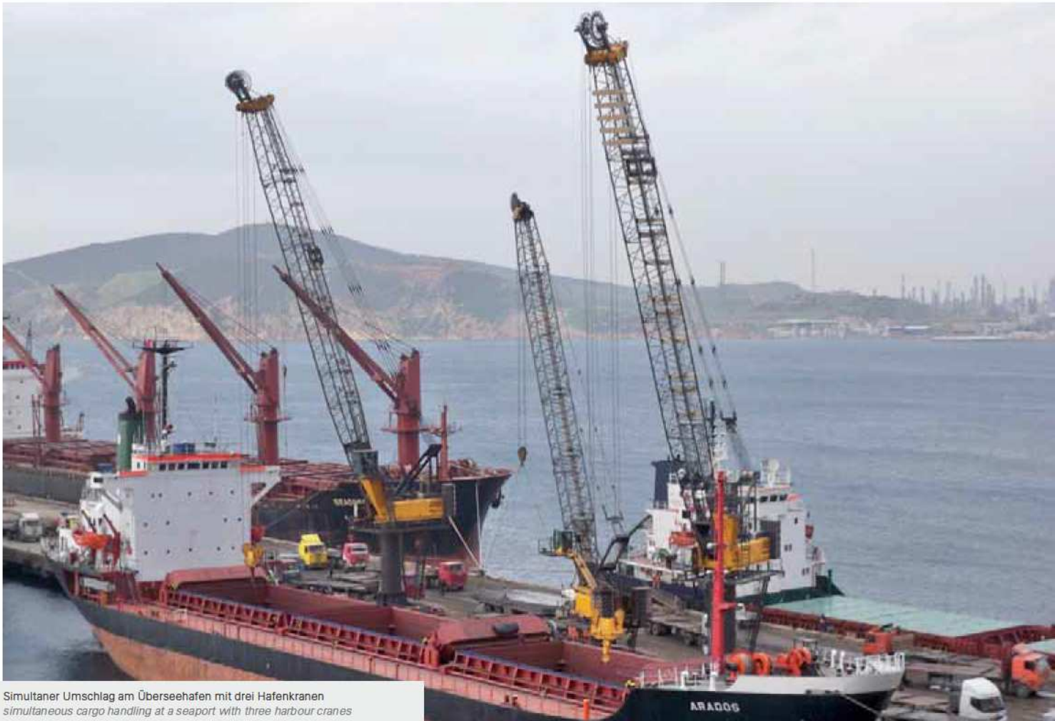
6180 HMC - 36 m Auslegerlänge mit Schnabelausleger - Schüttgutumschlag - England 6180 HMC - 36 m boom length with auxiliary jib - bulk handling - England
