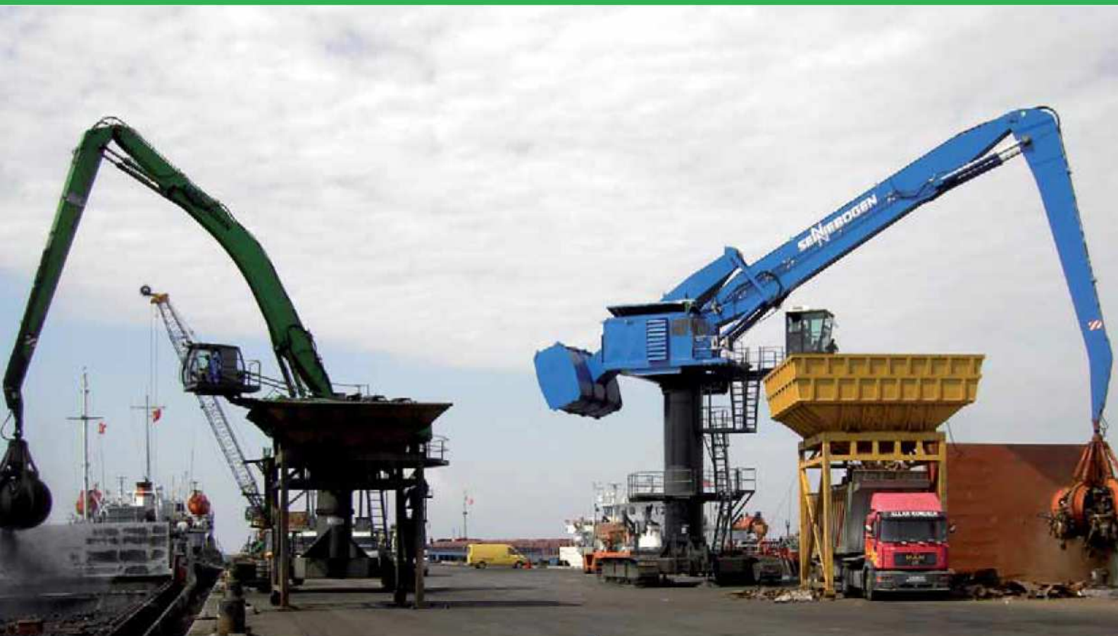
880 EQ R spezial - Ausrüstung K30 - Schrotturnschlag mit Mehrschalengreifer 8 m 3 - Türkei 880 EQ R special - equipment K30 - scrap handling with orange-peel grab 8 m 3 - Turkey
