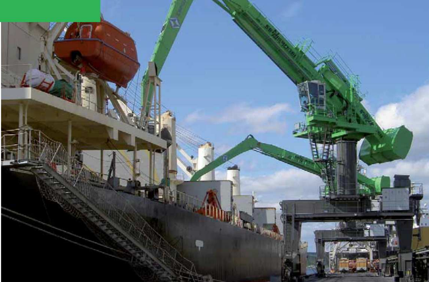
880 EQ Elektro - Schienen Portal - 6 m Durchfahrthöhe, 10,5 m Spurbreite - Ausrüstung K30 - 15 m Sichthöhe aus Kabine - Eisenerzschlag mit Zweischalengreifer 4 m 3 - Russland 880 EQ electro - rail gantry - 6 m clearance height, 10.5 m track width - equipment K30 - 15 m operator eye level - iron ore handling with clamshell grab 4 m 3 - Russia
