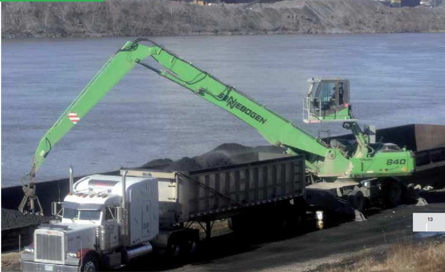
840 M - Ausrüstung K17 - Kohleumschlag mit Zweischalengreifer 3 m 3 - USA 840 M - equipment K17 - coal handling with clamshell grab 3 m 3 - USA
