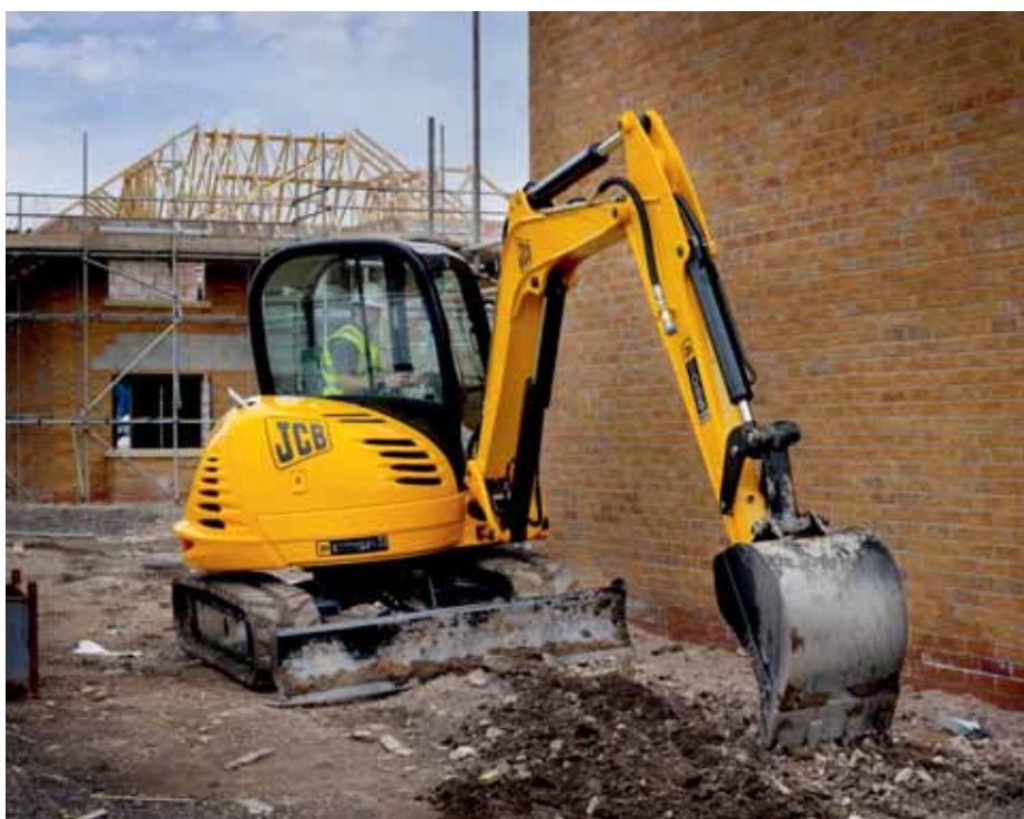
A csökkentett farkkinyúlás (RST) megkönnyíti a szűk helyeken történő munkavégzést
